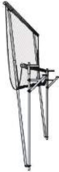
Figura 5.2.2-1 Esempio di sistema T (chiuso)
