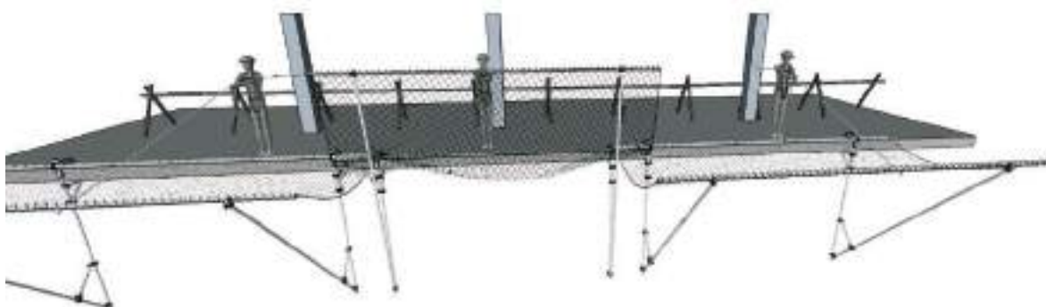
Figura 7.2.3-4 Montaggio del sistema T
