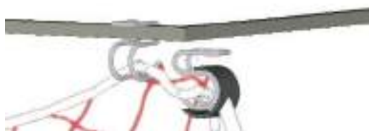
Figura 7.2.2-2 Dispositivo di aggancio remoto Particolare della fase di aggancio
