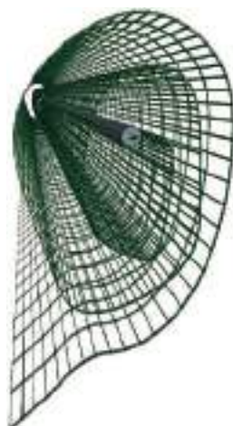
Figura 7.3.1-4 Arrotolamento della rete (preferibile)
