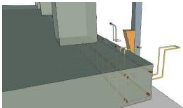
Figura 7.3.4-2 Montaggio di omega, perno, gancio di sicurezza e cuneo
