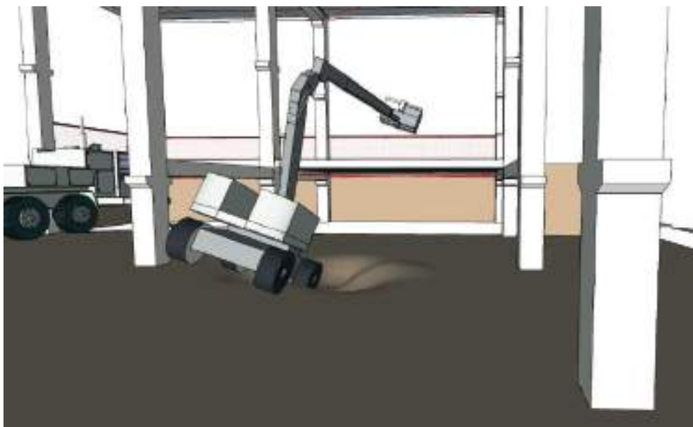
Figura 7.2.3-1 Rischio nell'utilizzo della PLE (condizioni del terreno)
