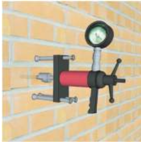
Figura A4.2-1 Test di trazione sull'ancorante
