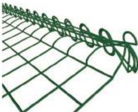
Figura 7.3.1-5 Raccolta della rete
