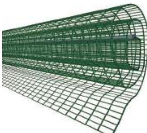
Figura 7.3.1-3 Arrotolamento della rete (preferibile)
