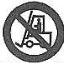
Vietato ai carrelli di movimentazione
